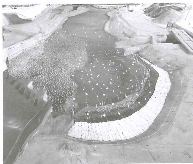
Hình 4. Hình ảnh mô hình thí nghiệm hạ lưu hồ chứa thủy điện Hòa Bình
